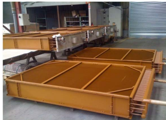
Echangeur type Batteries à ailettes: traitement de surface anticorrosion
